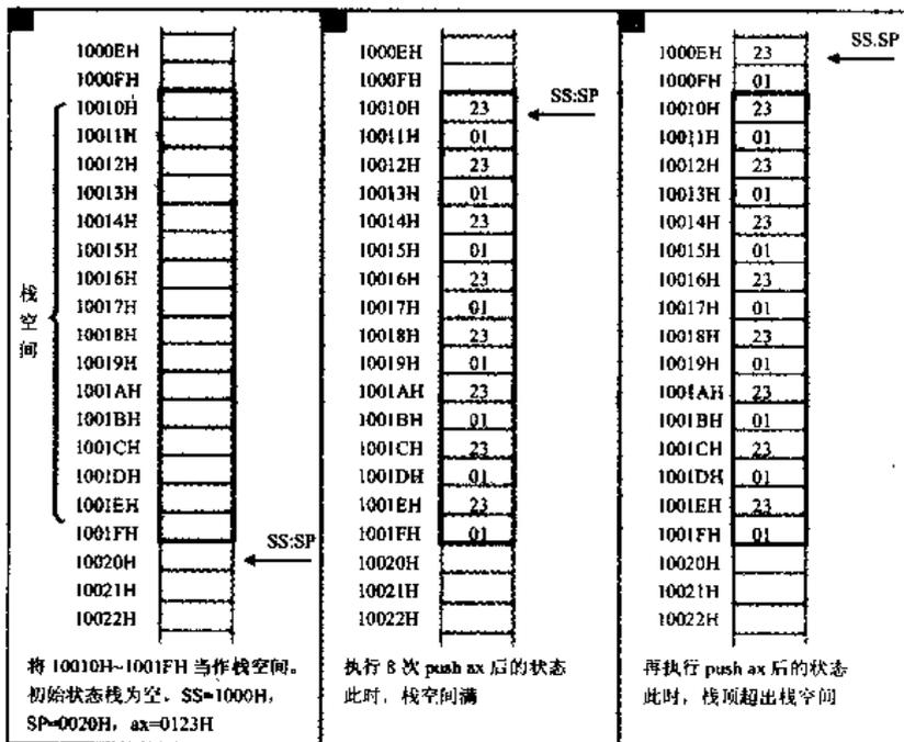
图 3.13 执行 push 后栈顶超出栈空间
