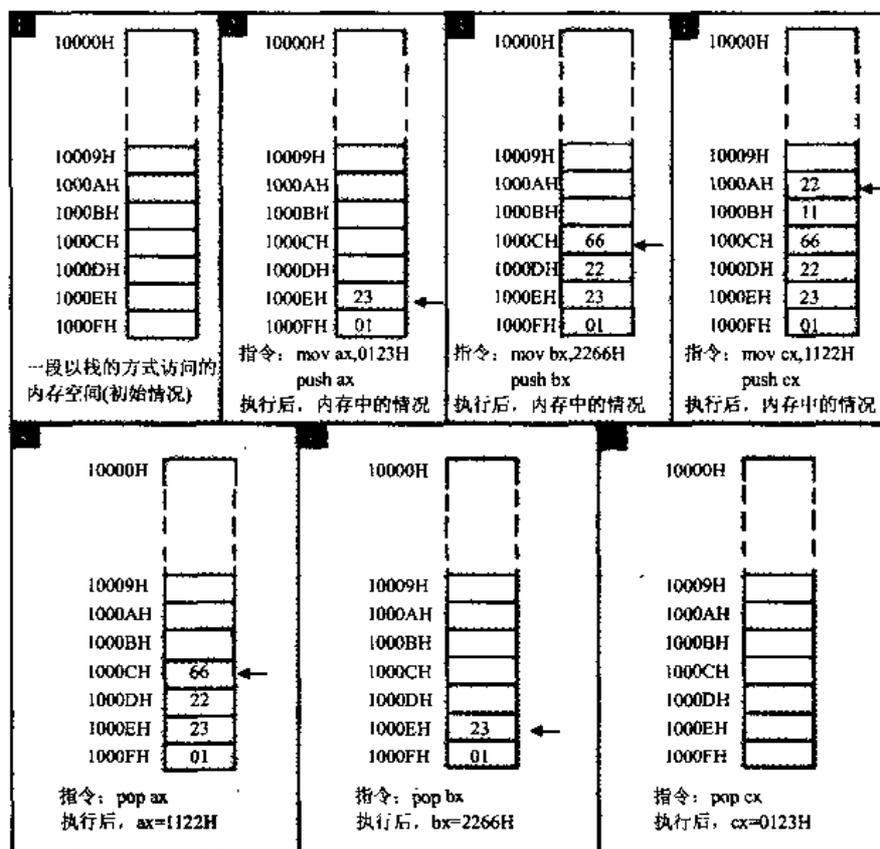
图 3.9 8086CPU 的栈操作
