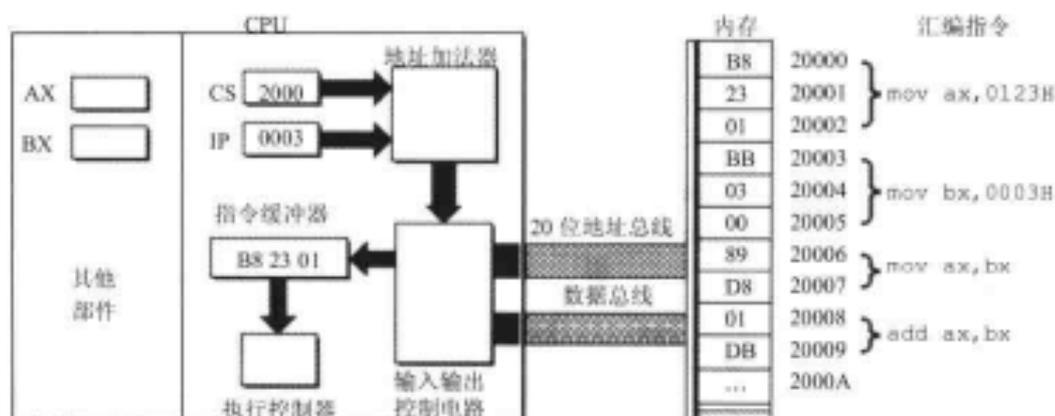
图 2.17 读取指令后 IP 中的值自动增加
