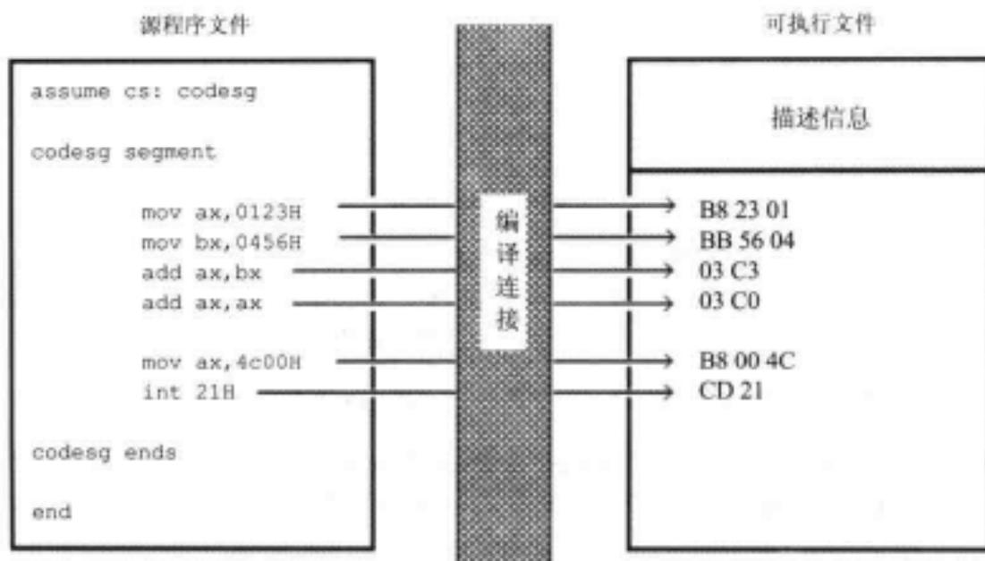
图 4.2 程序经编译连接后变为机器码
