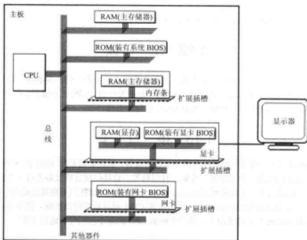
图 1.7 PC 机中各类存储器的逻辑连接
