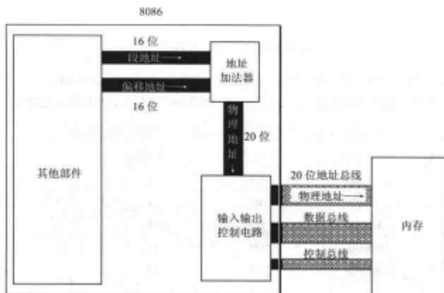
图 2.6 8086CPU 相关部件的逻辑结构
