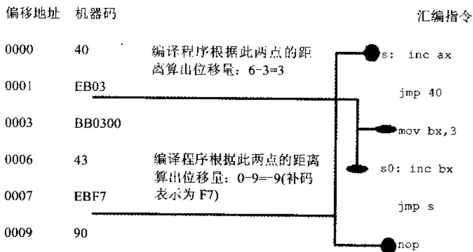
图 9.3 转移位移的计算方法
