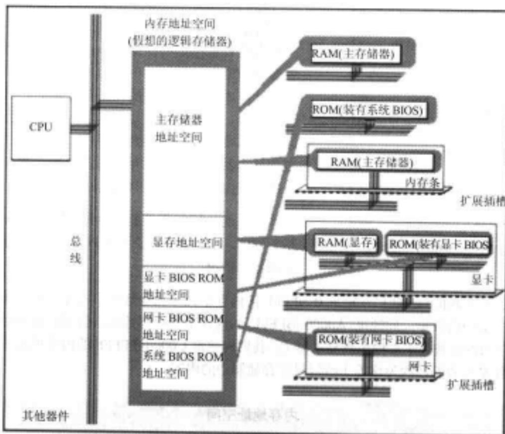
图 1.8 将各类存储器看作一个逻辑存储器
