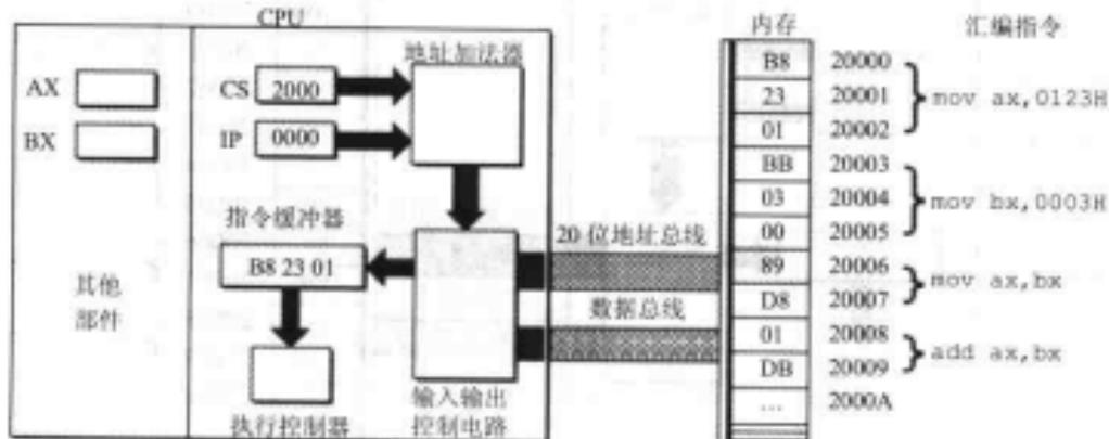
图 2.16 机器指令被送入指令缓冲器
