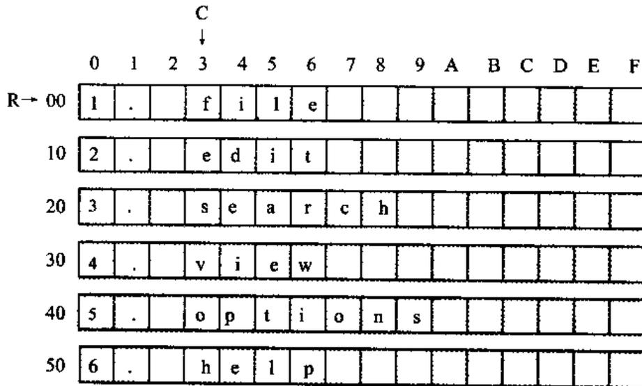
图 7.2 datasg 中数据的存储结构
