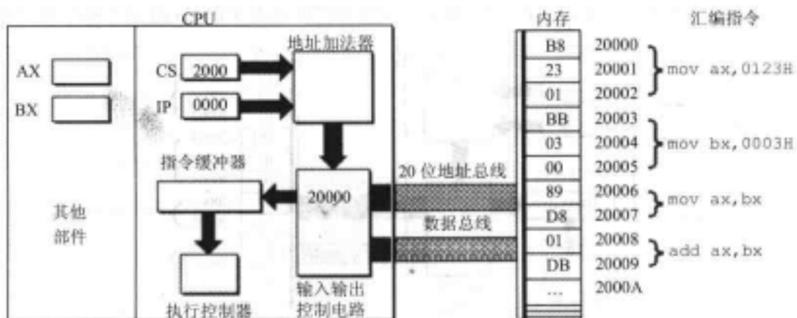
图 2.13 物理地址被送入输入输出控制电路
