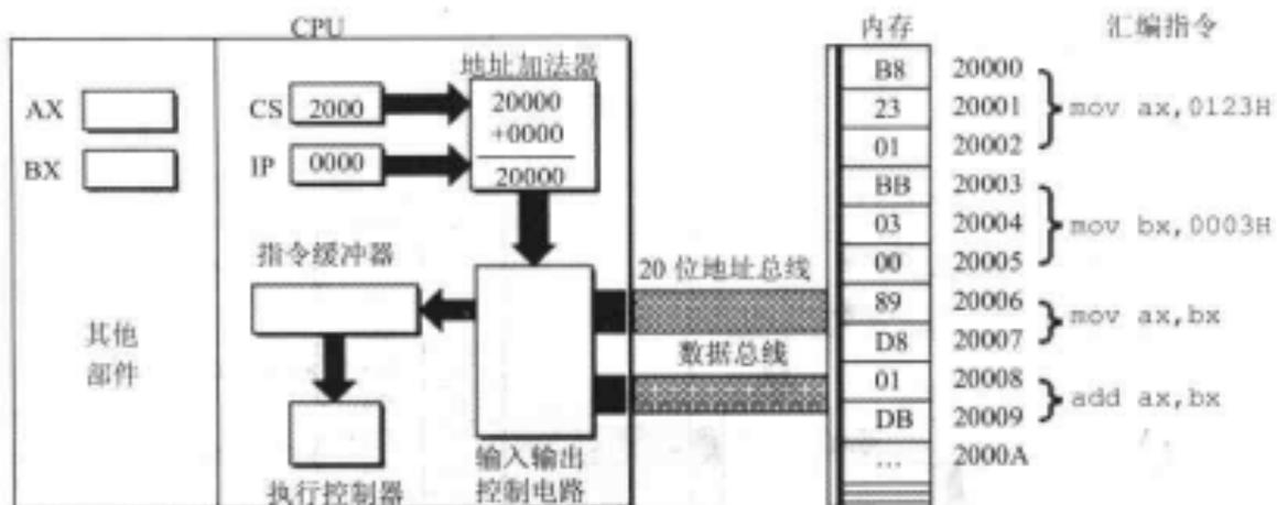
图 2.12 CS、IP 中的内容送入地址加法器
