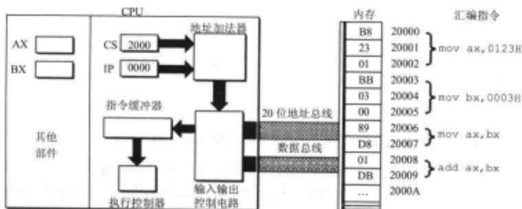
图 2.10 8086PC 读取和执行指令的相关部件
