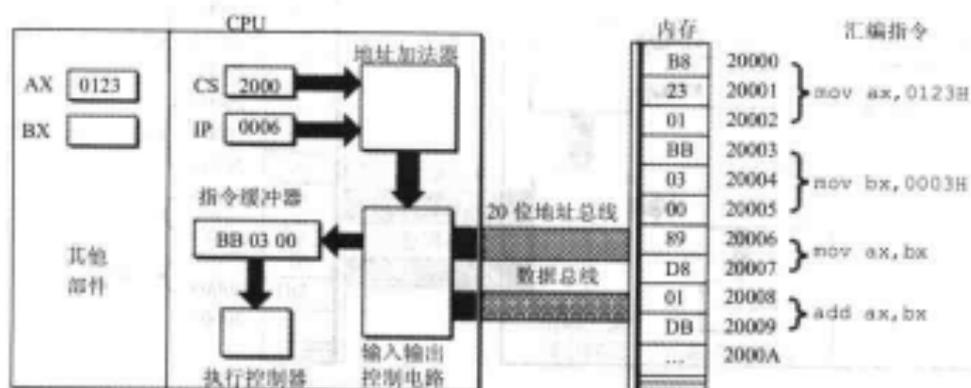
图 2.21 第二条指令被读入指令缓冲器
