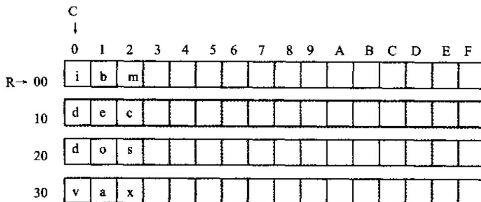
图 7.3 `datasg` 中数据的存储结构
